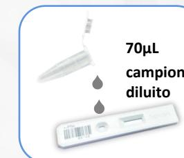
3 70µL di campione diluito nel pozzetto del dispositivo e attendere 15 minuti.
