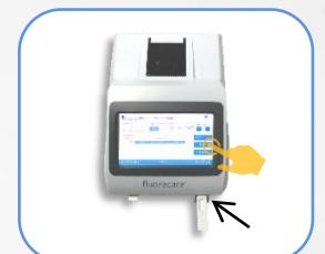
4 Inserire il dispositivo nell'analizzatore. Premere **【Test】** e attendere il risultato.
