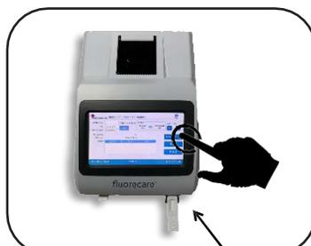
**8** Inserire il dispositivo nell'analizzatore. Cliccare **【Test】** e leggere il risultato e cliccare **【Print】** se si vuole stampare il risultato.
